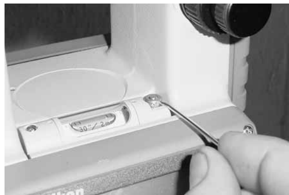
Teodolito girado 180° para la comprobación de nivel del paso 8
