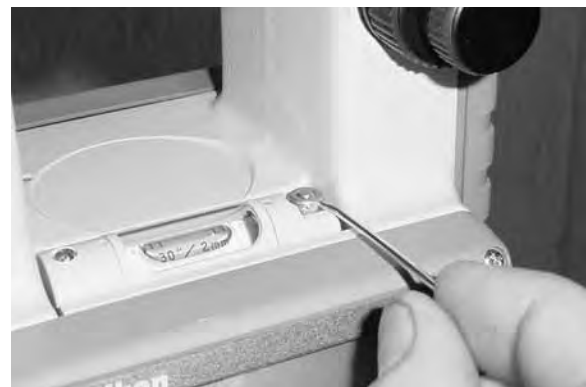
Teodolito Girado 180° para verificar o nível na Etapa 8
