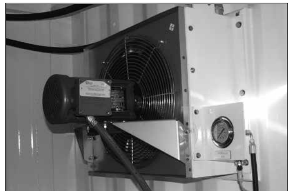
SN FA21965F Oil Cooler Fan Shown
